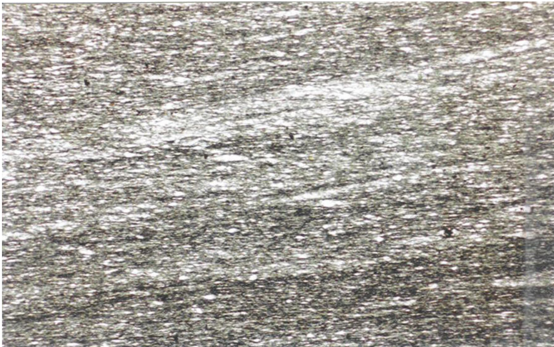
Dünnschliffaufnahme, ca. 40 fach, einfach polarisiert
