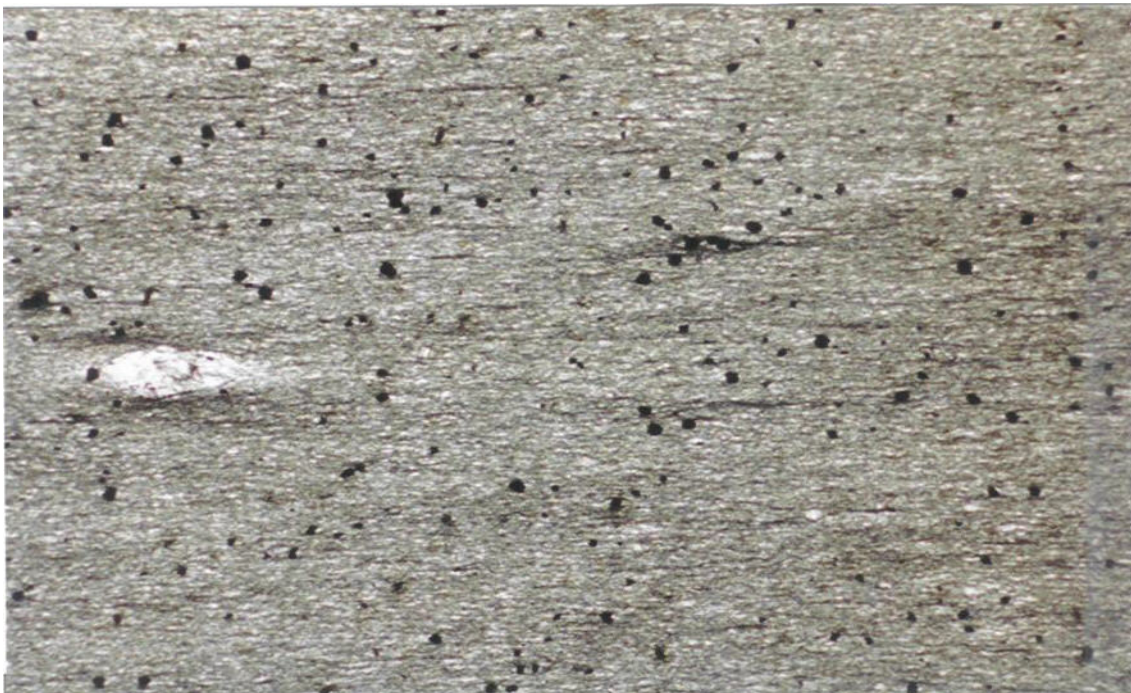
Dünnschliffaufnahme, ca. 40 fach, einfach polarisiert
