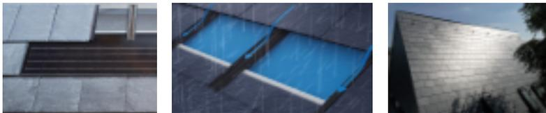
Dachfläche (Minstdachneigung 25° bis max. 6m Sparrenlänge bzw. 30° ab 7m Sparrenlänge, Sparrenabstand (lichte Weite: max. 60cm) mit dem Rathscheck Schiefer- System nach den Rathscheck- Verlegerichtlinien eindecken.
